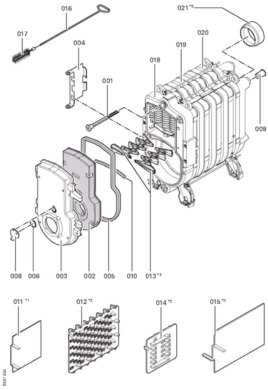
Chaînage 7198310 Chaudière Vitorond 100 VR2B 50kW Segm.
