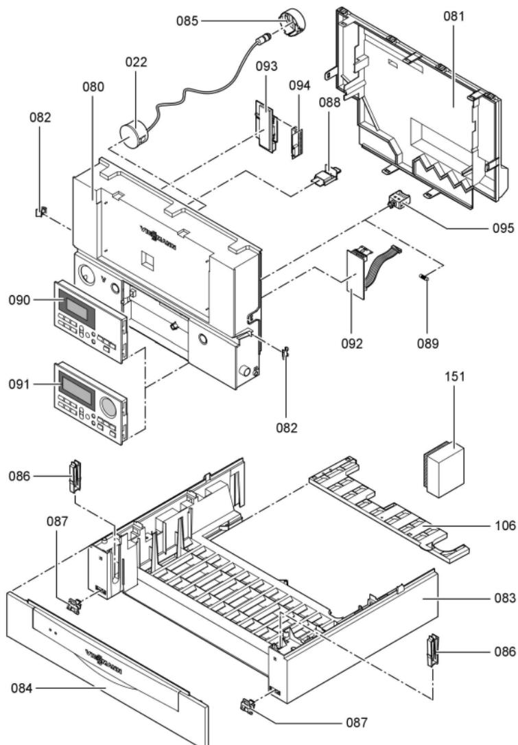
Chaînage 7199540 Corps Vitodens 300-W WB3C s.s 35kW
