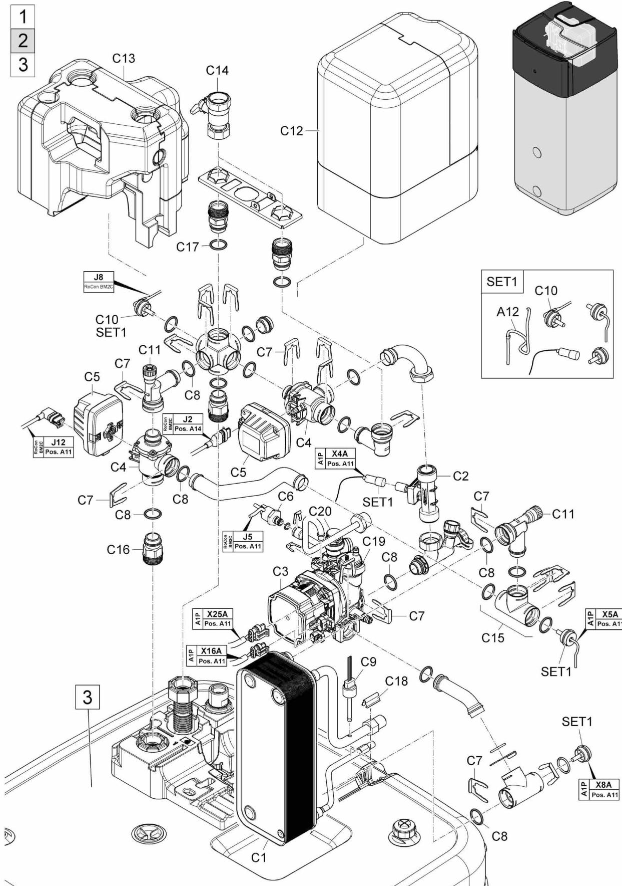
**HPSU compact Ultra 508 (H/C) - Wärmetauscher**
