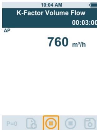
Ce procédé de détermination du débit volumétrique peut être utilisé partout où le fabricant de l'élément fournit les spécifications correspondantes. Selon ces spécifications, la pression différentielle est mesurée sur une position déterminée par le fabricant ou fournisseur. Le facteur k spécifique au composant permet de déterminer le débit volumétrique à partir de la pression différentielle au moyen de l'équation mathématique suivante :
