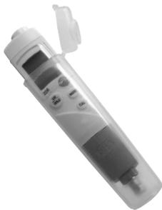
Le TopSafe protège l'appareil de l'humidité et des contraintes mécaniques (coups). Nous recommandons d'utiliser le TopSafe en toutes circonstances.
