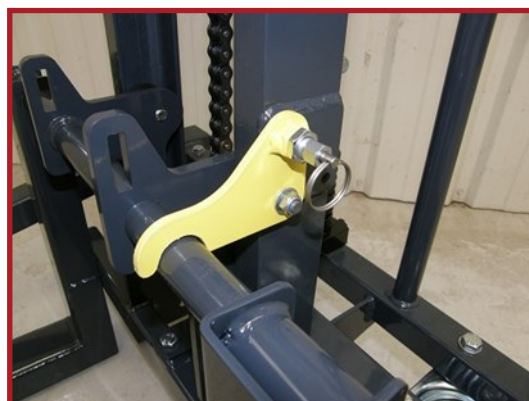
Dispositif de blocage du tablier pour son transport sécurisé
