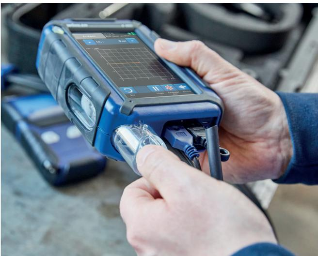
Entretien simplifié : Le pot à condensation s'enlève et se repositionne facilement.
