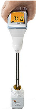
5. Plonger le capteur dans l'huile de référence. Respecter la profondeur d'immersion !
