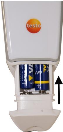
4. Mettre le couvercle en place sur le compartiment à piles.
