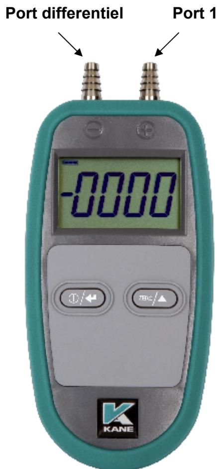
**Utilisez toujours le port en haut à droite (Port 1) pour prendre des mesures simples (pression ou dépression).** Utilisez seulement le port en haut à gauche pour les mesures différentielles.
