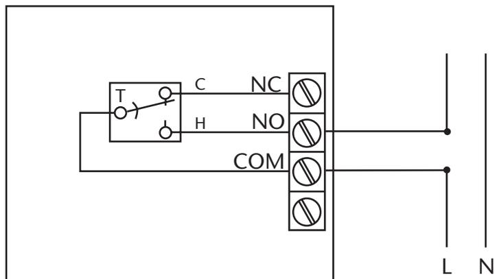
Terminal NO pour une utilisation en mode chauffage. Terminal NC pour un mode refroidissement
