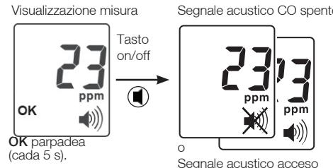
Segnale acustico CO on: L'allarme suona (diventa più veloce all'aumentare della concentrazione di CO): parte a 10 ppm, suono continuo oltre 50 ppm.
