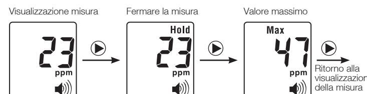
Reset del valore max. (al valore di misura corrente): in modalità Max, premere +
