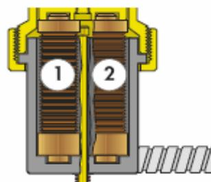
**POSE** La sonde de température doit être installée au plus près de la chaudière, sans aucun organe de réglage ni de fermeture entre le foyer et la sonde
