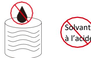
4) L'immersion du pistolet pulvérisateur dans l'eau n'est pas autorisée, afin d'éviter toute dégradation des pièces intérieures.
