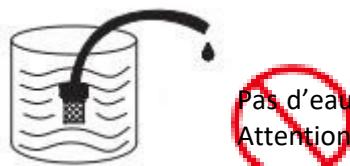
Assurez-vous que le tuyau d'arrivée est dans le seau, démarrez l'appareil en mode "COOL" afin d'éviter à la machine de fonctionner à vide et de se mettre en sécurité. Le mode "STEAM" doit être utilisé avec de l'eau propre.
