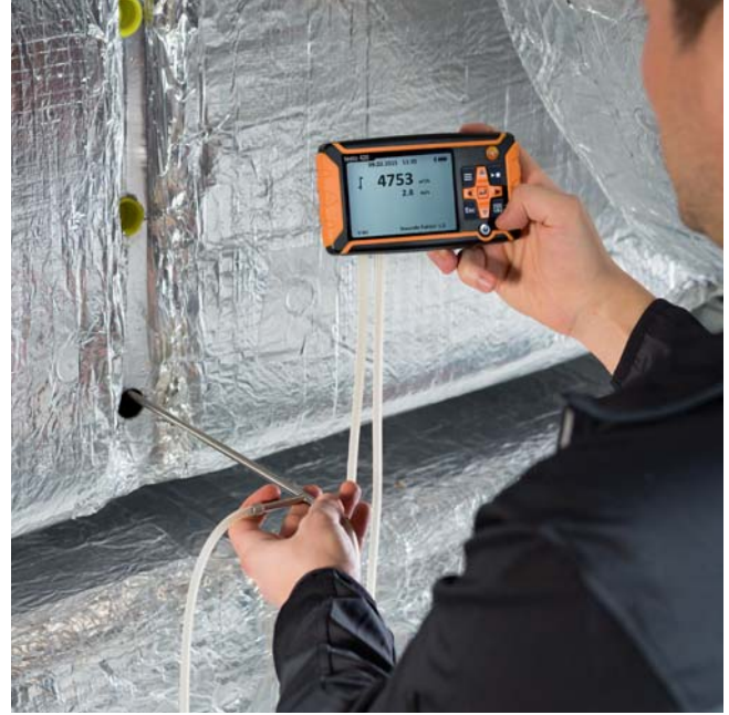
Appareil amovible permettant des mesures dans les conduits au moyen d'un tube de Pitot (tube de Pitot disponible séparément)
