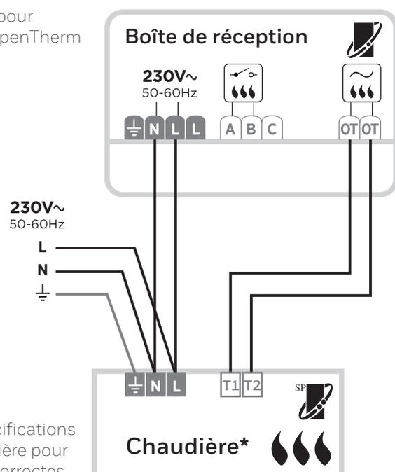
\* Voir les spécifications de la chaudière pour les bornes correctes.
