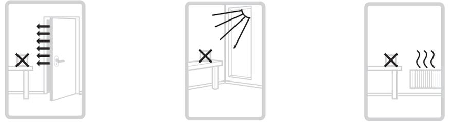
Le thermostat T6R ne doit pas être installé à l'abri des courants d'air, de la lumière du soleil et des sources de chaleur.
