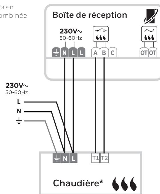
C) Câblage pour chaudière OpenTherm
