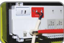
**11** Enfoncez les câbles CO en bas à droite du KL08RF pour la commutation chauffage/rafraîchissement sans tension. Un interrupteur ouvert correspond au chauffage (LED rouge). Un interrupteur fermé correspond au refroidissement (LED bleue). Remarque : créez les connexions uniquement pour un système de rafraîchissement.
