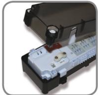
**4** Coupez le câble d'alimentation et le câble de l'appareil à la longueur souhaitée.
