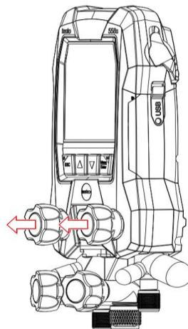
2 Déplier le crochet de suspension, défaire le clip, retirer le couvercle du compartiment à piles et retirer les piles.
