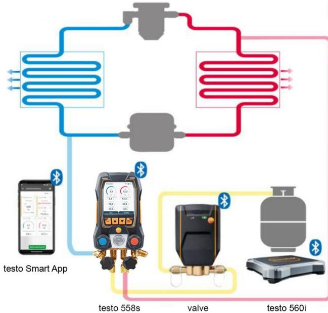
En association avec la balance **testo 560i** et la vanne **testo Smart Valve**, le manifold **testo 558s** offre plusieurs fonctions de charge de circuits de fluide frigorigène.
