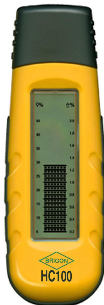
**Le HC100 (6503)** est utilisé pour mesurer le taux d'humidité dans le bois, carton et papier ainsi que dans les matières dures telles que le plâtre, le béton et le mortier. La capsule de protection comprend un circuit de test pour vérifier de fonctionnement de l'appareil et le niveau de la batterie.
