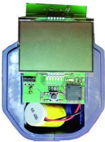
Imm. 45: Remplacement de la pile
