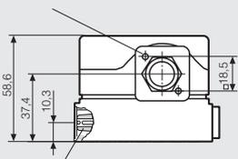
Prise de mesure intégrée, ø 9
