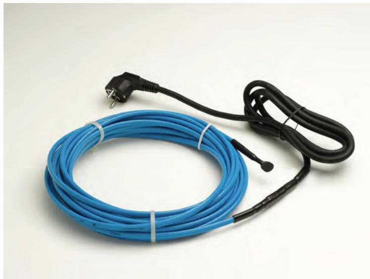
Câble autorégulant prêt à l'emploi d'une puissance de 10 W/m à 10°C dans l'air pour les applications de protection contre le gel des conduites d'eau. Le Pipeheat est livré avec 1,5 m de liaison froide et une fiche électrique.
