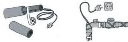
Le câble Pipeheat 10 à une capacité de protection contre le gel les tuyaux de diamètre maximum 50mm soumis à une température de -25°C, à condition de respecter un calorifugeage suffisant (1 x diamètre de tuyau).
