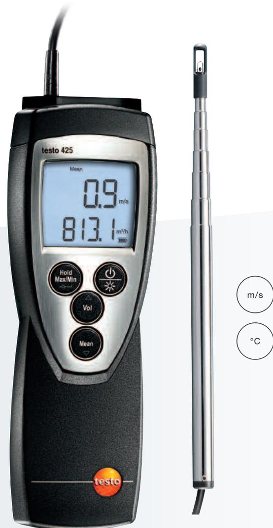
Le testo 425 est un anémomètre compact avec sonde fil chaud télescopique déportée.
