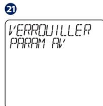
Cette option vous permettra de verrouiller vos paramètres avancés à l'aide de votre MDP. En utilisant HAUT ou BAS, créez vos paramètres de verrouillage avancés, puis VALIDATION pour confirmer.
