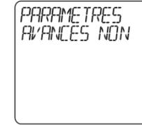
Si vous sélectionnez NON, le thermostat utilisera les réglages d'usine et retournera à l'écran de départ.
