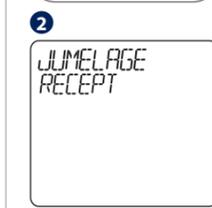
Éteignez le récepteur et rallumez-le deux fois pour le réinitialiser. Assurez-vous que les commutateurs du récepteur sont sur ON et AUTO. La LED rouge doit clignoter. Entrez dans le MENU du thermostat et faites défiler vers le bas jusqu'à ce que vous voyiez l'option «JUMELAGE RECEPT». Sélectionnez OUI pour procéder à l'appairage.
