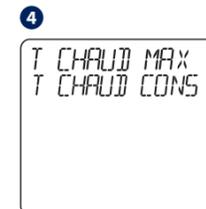
Appuyez sur VALIDATION pour accéder au menu. Avec HAUT ou BAS, régler la température maximale du chauffage central openTherm.
