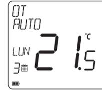
Une fois que vous avez correctement connecté votre thermostat aux contacts OpenTherm, le message OT apparaît à l'écran. Pour plus de détails sur OpenTherm, consultez la section OpenTherm: Configuration.
