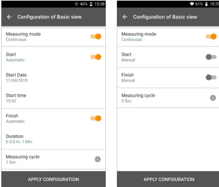
1 Cliquer sur **Appliquer la configuration (Apply Configuration)** pour démarrer la mesure (en cas d'heure de début planifiée).
