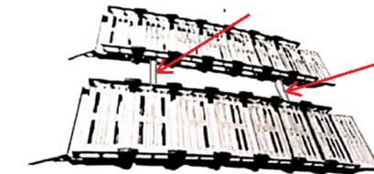
9. Si se instalan barandillas en las rampas, compruebe que los tornillos de sujeción estén bien apretados y, si no lo estuvieren, apriételos.
