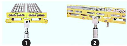
4. La rampa ha una staffa aggiuntiva montata in fabbrica che non richiede montaggio o smontaggio. Questo dovrebbe essere usato quando la rampa è montata ad un'altezza di 65 - 100 cm ed è lunga 3 - 4 m.
