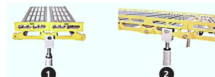
4. La rampa posee un soporte adicional instalado de fábrica que no requiere montaje ni desmontaje. Úselo cuando la rampa se instale a una altura de 65 – 100 cm y mida 3 – 4 m de longitud.
