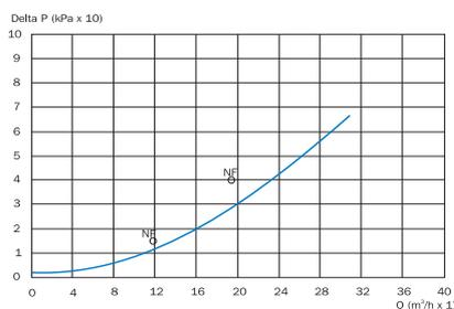
**Clapet WF et BB DN 50**
