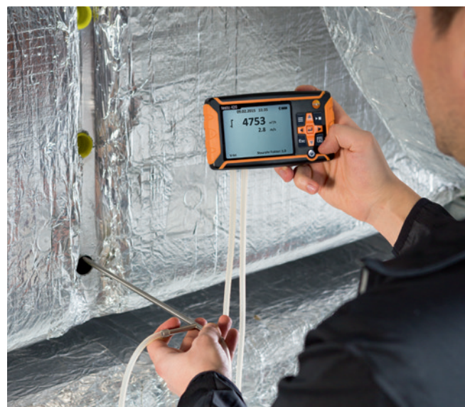
Appareil amovible permettant des mesures dans les canalisations au moyen d'un tube de Pitot (tube de Pitot disponible séparément)
