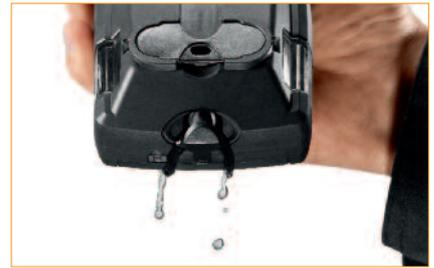
Ecran rétro-éclairé permettant une lecture aisée des données. Le testo 310 est équipé d'accus d'une autonomie de 10 heures. Le pot de condensation intégré est protégé des chocs.
