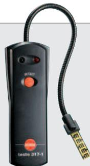
Le détecteur de refoulement testo 317-1 met en évidence une fuite sur les gaz de combustion. L'appareil donne automatiquement une alarme optique et sonore. Aucun contrôle visuel sur l'appareil n'est ainsi nécessaire. La sonde flexible (col de cygne) permet une utilisation dans les endroits les plus étroits.
