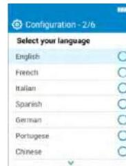
Sélectionner la langue en appuyant sur les touches Haut et Bas et valider avec OK.
