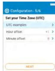
Régler le fuseau horaire en appuyant sur OK sur chaque ligne, utiliser les touches Haut et Bas pour sélectionner le bon élément et valider avec OK puis aller sur "Suivant".
