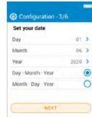
Régler la date en appuyant sur OK sur chaque ligne, utiliser les touches Haut et Bas pour sélectionner le bon élément et valider avec OK puis aller sur "Suivant".
