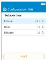
Régler l'heure en appuyant sur OK sur chaque ligne, utiliser les touches Haut et Bas pour sélectionner le bon élément et valider avec OK puis aller sur "Suivant".
