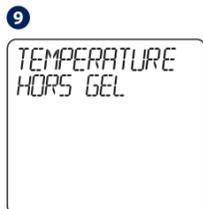
9 En utilisant VALIDATION, puis HAUT et BAS, vous pouvez sélectionner la valeur HORS GEL (5 - 17 degrés C). Appuyez sur VALIDATION pour confirmer ou BAS pour afficher l'option suivante.
